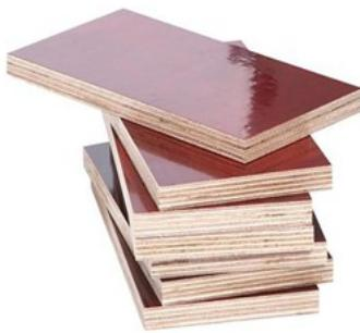
单板质量单板的质量，特别是其表面状态，对结合强度有很大影响。在木段的制备和单板切割过程中应充分注意单板的质量。需要对木材并进行软化处理，并控制旋转切割的条件，使单板的各种指标处于比较好值。同时，应注意单板。水分含量和平整度。在压制胶合板胶之前，应注意掌握胶水和板坯的数量陈化。胶量太大，成本高；胶层太厚，内应力增大，胶水容易渗透；胶量太小，不利于胶水的渗透，胶水层也会不完整。老化时间的长短应适当，并随气候变化而变化。要实现板张化，减少板堆叠和分离。必须注意掌握橡胶条的压力和压力，特别是在板坯中。
